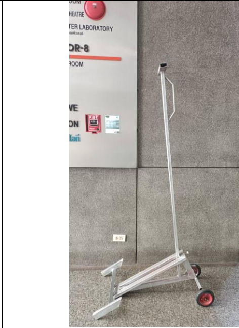
อุปกรณ์ที่ได้ มี 2 หัว สำหรับยกโต๊ะ และเก้าอี้
